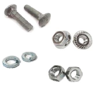
Tornillería de 1/4" electrogalvanizada para uniones. Esta tornillería esta compuesta por 4 unidades para uniones normales y 8 para uniones fondo sólido, cada una ellas puede ser suministradas de las siguientes formas: tornillo de carruaje y tuerca hexagonal dentada o tornillo de carruaje, tuerca hexagonal y arandela de presión. Recuerde que la tuerca dentada o con flange no requiere arandela de presión ni plana dando ahorro en la instalación.
