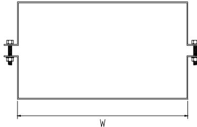
Hechos con lámina de hierro espesor 1,5 mm galvanizada bajo norma ASTM 653. El sujeta tapa doble es recomendado en instalaciones donde las altas vibraciones o fuertes vientos son un problema y para montajes verticales. Se deben colocar dos sujeta tapa doble en uso interior, tres en uso exterior y 4 en zonas de fuertes vientos. La tornillería es de 1/4" y se suministra por separado.
